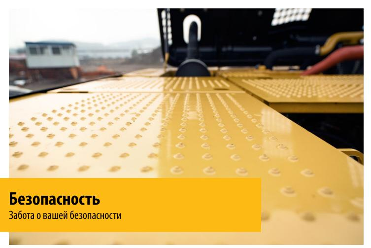
Противоскользящие накладки и болты с потайной головкой снижают риск поскальзывания и спотыкания, обеспечивая **безопасность** для проведения планового технического обслуживания и необходимых ремонтных работ на платформе.
