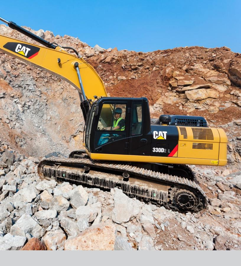
Машина 330D2 L оснащена рядом новых технологий и функций, позволяющих получить максимум от вашего оборудования. Изохронное управление частотой вращения коленчатого вала двигателя, новая система фильтрации топлива и встроенный экономичный режим обеспечивают сокращение расхода топлива. Вентилятор с частотно-регулируемым приводом с вязкостной муфтой обеспечивает производительность, эффективность и безопасность.
